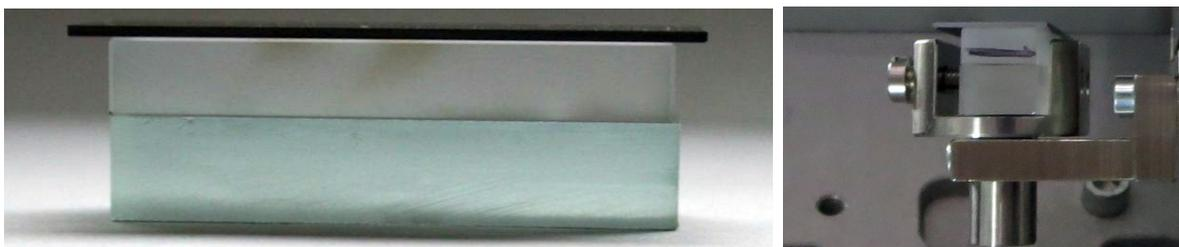
**Abbildung 3.36:** Fertig präparierter SOI-Kristall für das Quasi-Channelcut Polarimeter.
