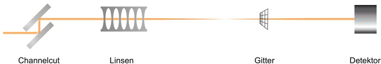
**Abbildung 5.17:** Schematischer Aufbau zum Test der Röntgenoptiken.
